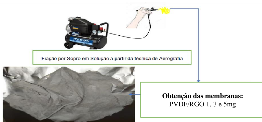
Figura 1. Fluxograma do processo de obtenção das membranas de PVDF/RGO.
