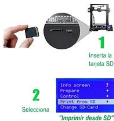
Figura 2. Introducción del código G a la impresora 3D.
