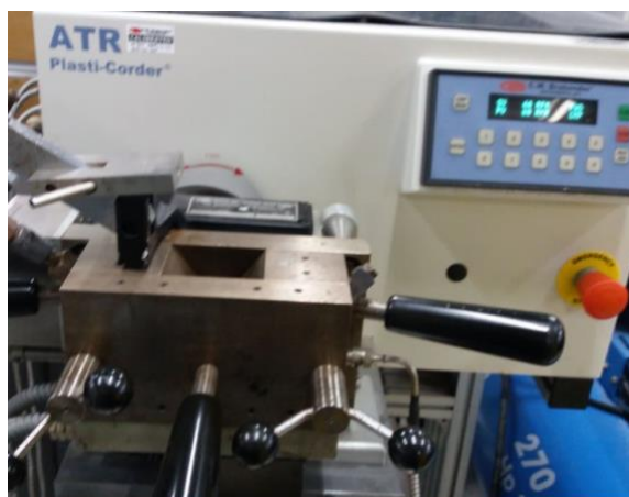
Figura 7. Mezclador Brabender utilizado. Fuente: Propia
