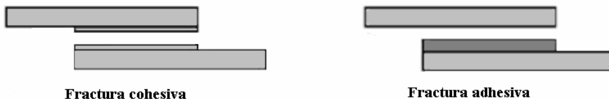
Figura 6. Tipos de fractura en las uniones adhesivas
