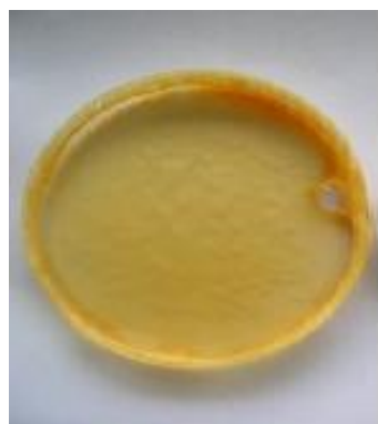
Figura 9. Material obtenido después del entrecruzamiento de la mezcla de gelatina, quitosano y dextrano, por medio del glutaraldehído y secado a 30^{\circ}\text{C} en horno de vacío.
