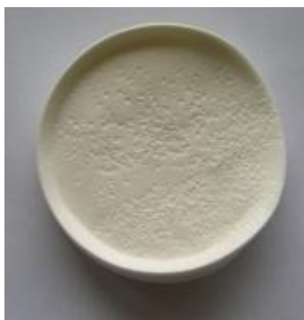
Figura 8. Material obtenido después del entrecruzamiento de la mezcla de gelatina, quitosano y dextrano, por medio del glutaraldehído y secado a -10^{\circ}\text{C} por liofilización.
