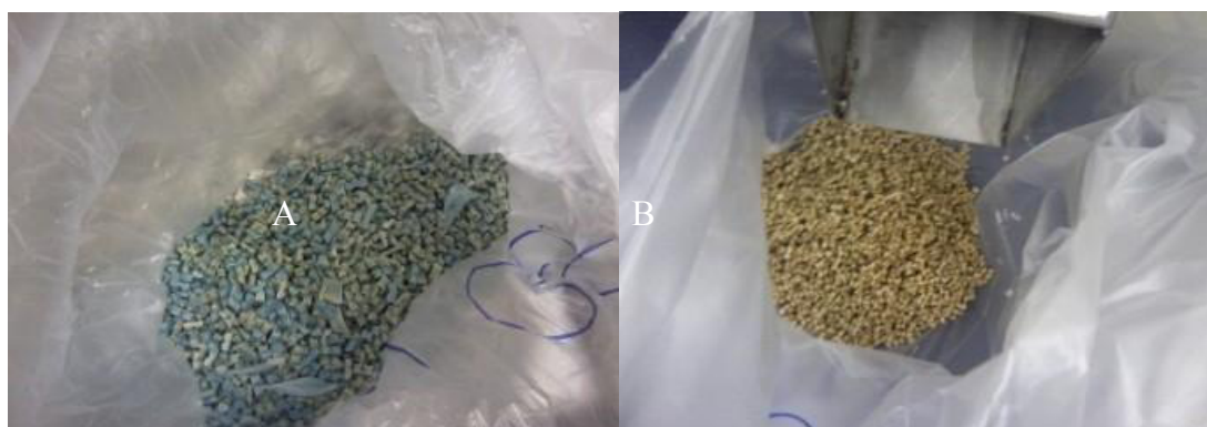
Figura 2. (A) PEAD virgem com pó de madeira, (B) PEAD pós consumo com pó de madeira.
