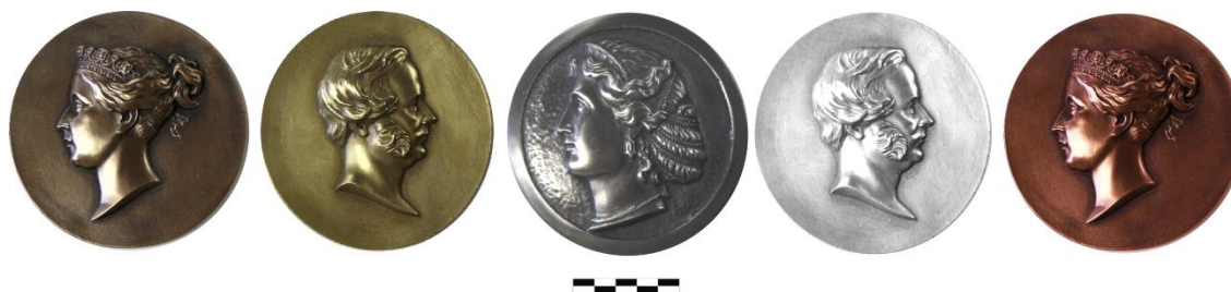
Figura 4. Diversas reproducciones artísticas de medallones, obtenidas por colada en molde de silicona RTV, con un contenido metálico del 70% p/p, y un tamaño de partícula de 106 \mu\text{m} . De izquierda a derecha: epoxi-bronce, epoxi-latón, poliéster-hierro, poliéster-aluminio y poliéster-cobre. Obsérvese el acabado metálico, brillante y pulido, que caracteriza una elección óptima de proporción y tamaño de partícula metálica y un correcto trabajo de pulido de la superficie.
