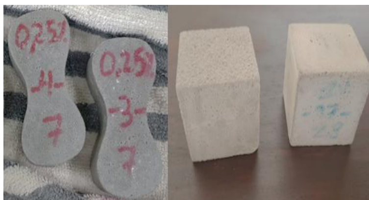
Figura 17. Briquetas (izquierda) y cubos (derecha) de mortero hidráulico fabricados según los requerimientos de las normas ASTM C307 y ASTM C109 respectivamente.
