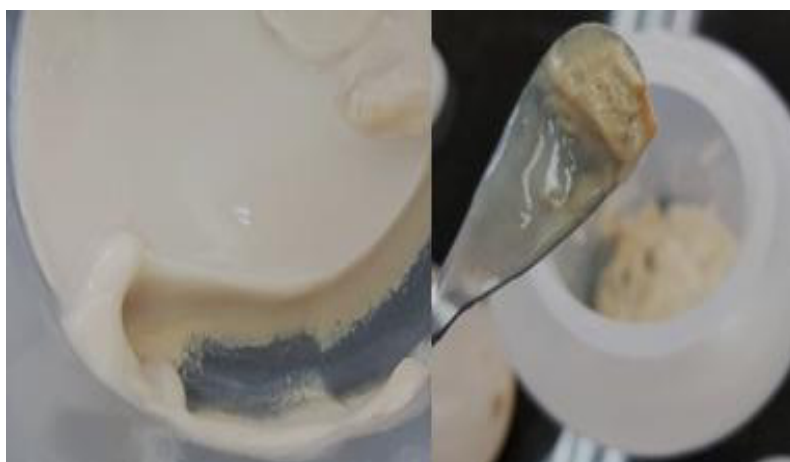
Figura 12. Centrifugación del sustrato completo obtenido de la hidrólisis ácida en H 2 SO 4 .
