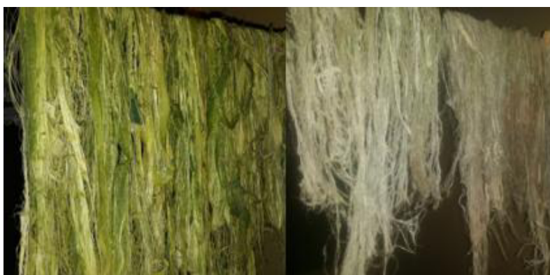
Figura 4. Fibras obtenidas de las máquinas descortezadoras en tendedores antes y después del secado.
