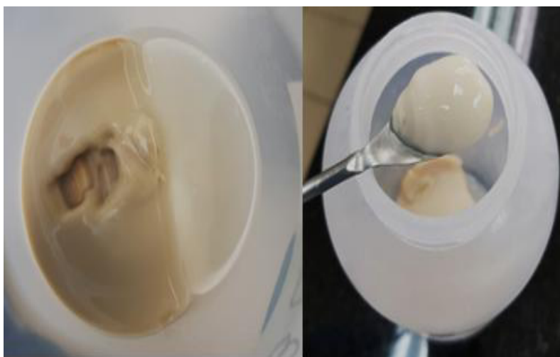
Figura 14. Centrifugación de nanocelulosa aislada del sustrato completo obtenido de la hidrólisis ácida en H_2SO_4 .
