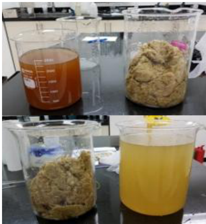
Figura 10. Reacciones de hidrólisis básica en NaOH al 20% (arriba) y NaOH al 12% (abajo).
