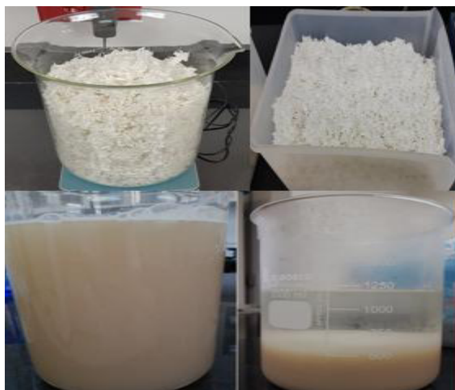
Figura 11. Fibra blanqueada obtenida de la reacción con NaClO y producto luego de ser sometido a la hidrólisis ácida con H 2 SO 4
